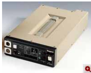
FE-C100A 光纖轉換器, 可連接至 FE-B100A Base station 當棚內機使用
